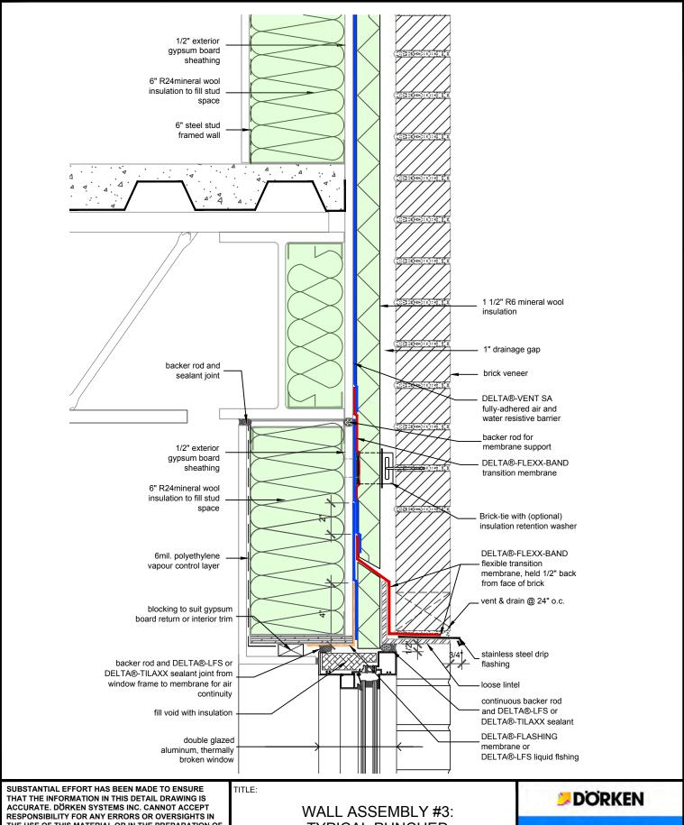
WALL ASSEMBLY #3: TYPICAL PUNCHED WINDOW SILL
